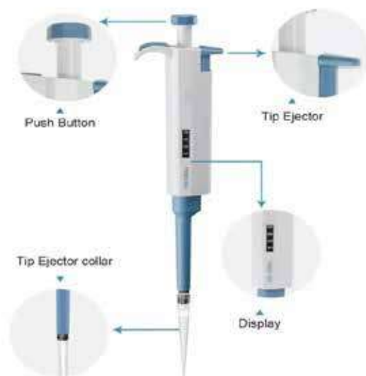
Figura 14. Micropipeta automática y sus partes.
